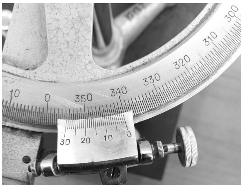
Рис. 3.10. Отсчет угла по шкалам лимба и нониуса гониометра
