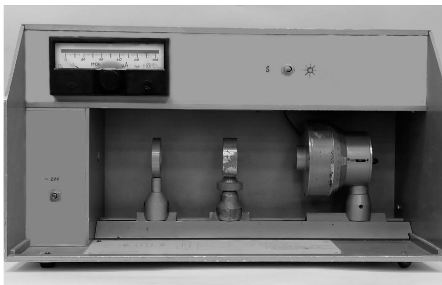
Рис. 4.7. Экспериментальная установка по исследованию поляризованного света
